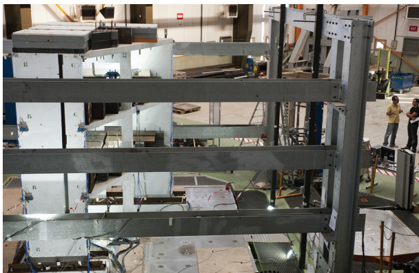
Figure 10.17. La maquette instrumentée SMART2011 (en support à un programme de recherche commun CEA/EDF) est représentative d'un bâtiment de « type nucléaire » à l'échelle 1/4. D'une masse d'environ 47 tonnes (incluant 36 tonnes de masses additionnelles), elle est instrumentée avec plus de 200 voies de mesure (accélérations, déplacements, déformations) et subit une séquence de sept séismes de niveau croissant. © P. Stroppa/CEA.
