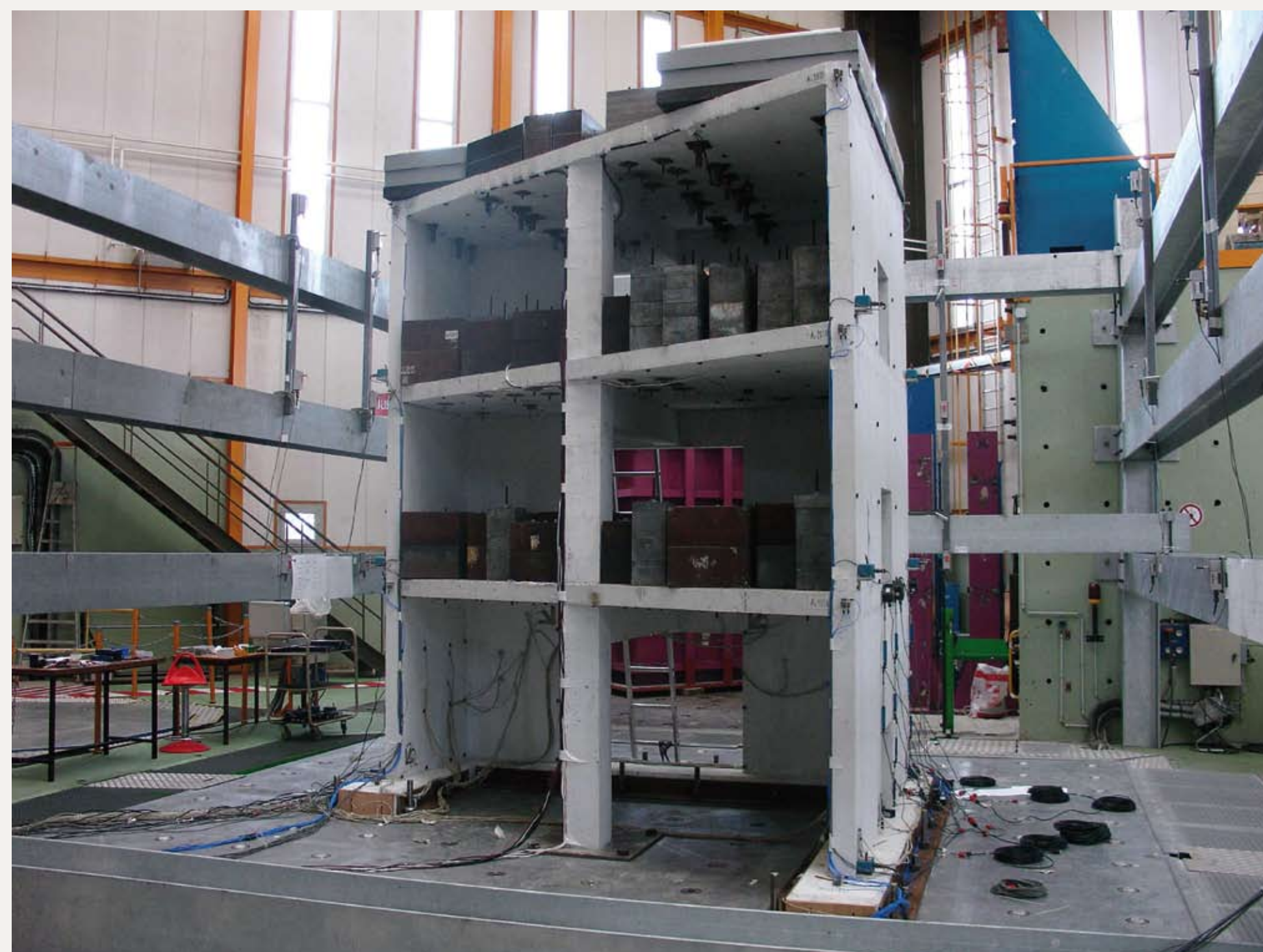
Maquette SMART sur table vibrante. Projet CEA-EDF
